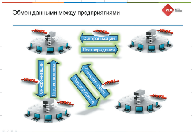
Рис. 15. Обмен данными между предприятиями с помощью модуля EASync для системы Lotsia PDM PLUS
