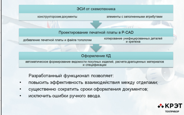
Рис. 4. Оформление конструкторской документации разводчиком печатной платы
